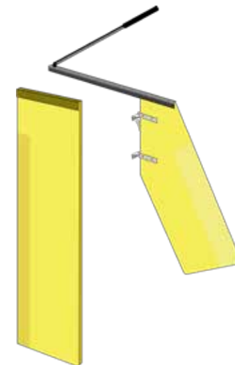
Шверт и руль с румпелем и удлинителем
