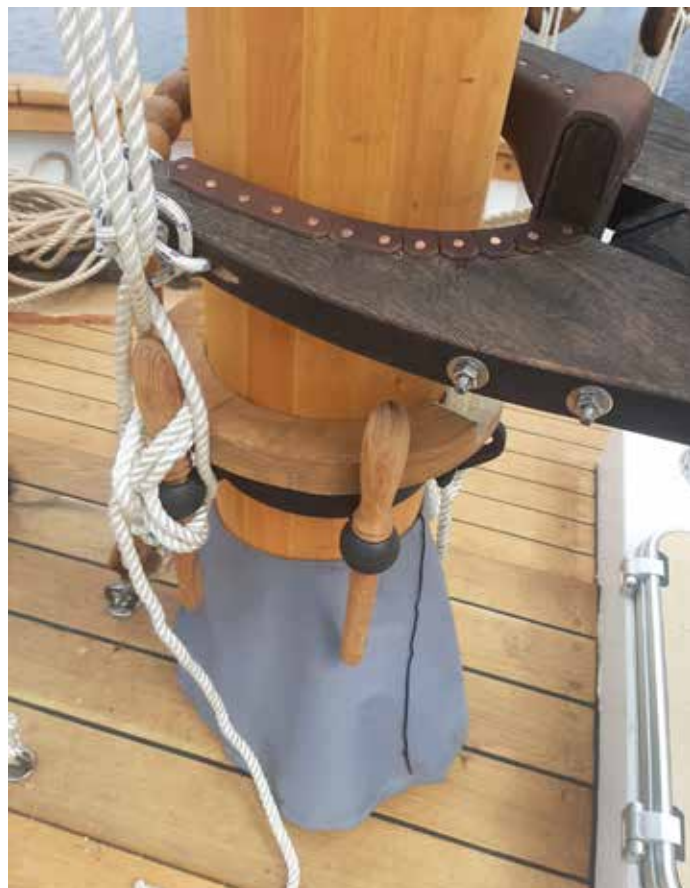
Пятка гика; ниже – нагели для крепления бегучего такелажа
