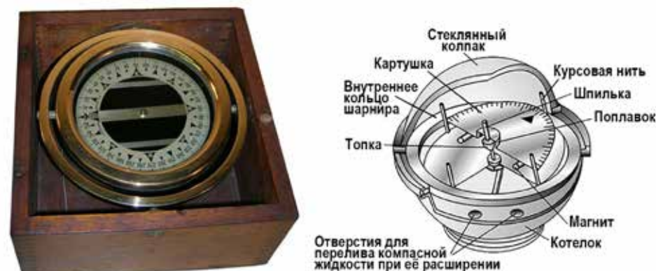
Картушка и схема устройства морского магнитного компаса
