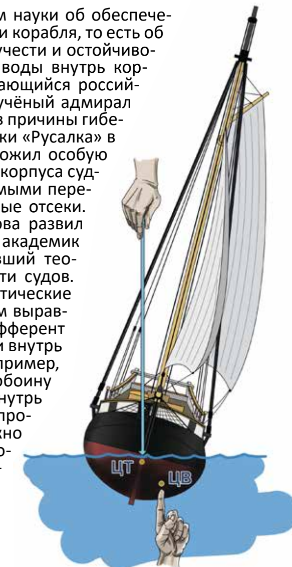
Силы, обеспечивающие плавучесть и остойчивость судна: вес, примененный к центру тяжести суд (ЦТ), тянет вниз, сила плавучести, или архимедова сила, примененная к центру величины (ЦВ), выталкивает вверх.
