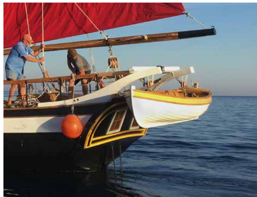
Шлюпка грузоподъёмностью 350 кг на кормовых шлюпбалках (боканцах) шхуны «Святая Татьяна».
