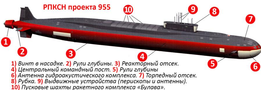
1) Винт в насадке. 2) Рули глубины. 3) Реакторный отсек.
