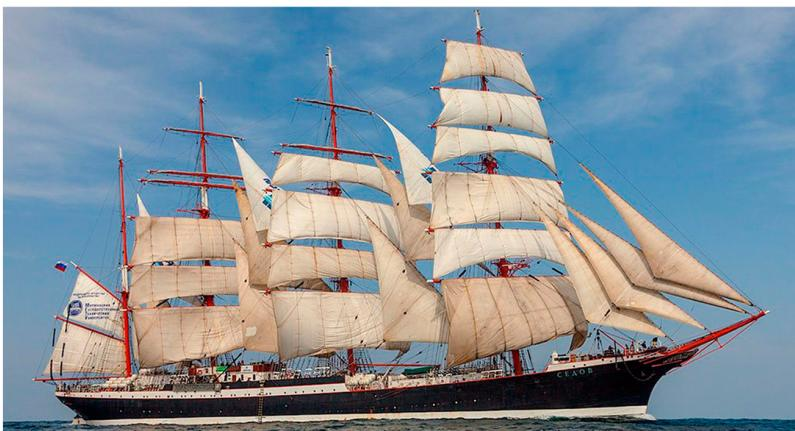
Барк «Седов» – крупнейшее из находящихся в эксплуатации учебных парусных судов. Его полное водоизмещение составляет 7320 т, длина с бушпритом – 117,5 м, ширина – 14,7 м, осадка – 7,5 м. Высота грот-мачты от киля до клютика – 63,5 м; площадь всех 32 парусов – 4192 кв. м. При постоянном экипаже в 64 человека барк может брать в плавание до 170 курсантов мореходных училищ.
