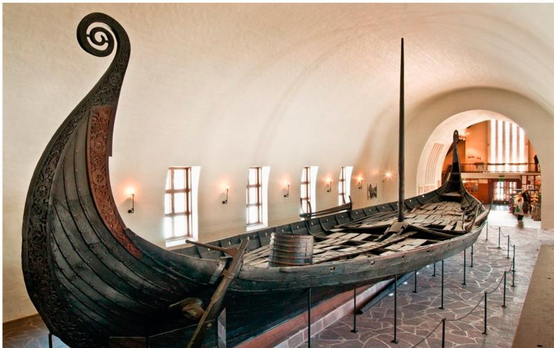
Квадратные паруса их лодок-драккаров при приведении к ветру поворачивались и создавали тягу. То есть своим успехом викинги обязаны не столько своим парусам, сколько удачной конструкции корпуса с мощным килем, который держал воду и препятствовал дрейфу. Как мы скоро увидим, хорошими мореходными качествами лодка обязана и корпусу, и парусному вооружению.
