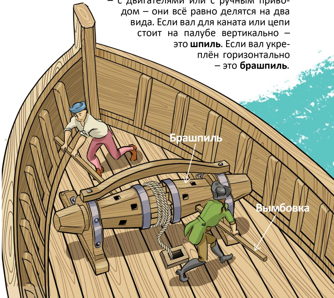
Шпиль представляет собой круглую ребристую тумбу с утолщениями внизу и вверху. В «голове» шпилля есть квадратные гнёзда для рычагов. Рычаги бывают длиной метра два, а то и больше. Называются **вымбовки**. На каждую наваливается по два-три человека, и – «Поднять якорь!»
