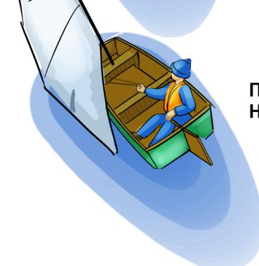
Теперь поставьте швертбот так, чтобы ветер дул ему с кормы примерно под 30°. Это курс бакштаг. Попробуйте правильно поставить парус относительно вымпельного ветра. Помните: гик должен делить угол между его направлением и ДП пополам.
