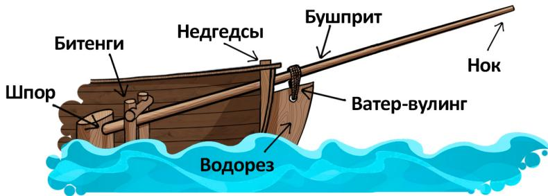
Шпор бушприта закрепляется между двумя крепкими брусьями - **битенгами**, которые идут от палубы до самого днища. Кроме того, к форштевню бушприт притягивается специальной скобой, она называется **ватер-вулинг**.
