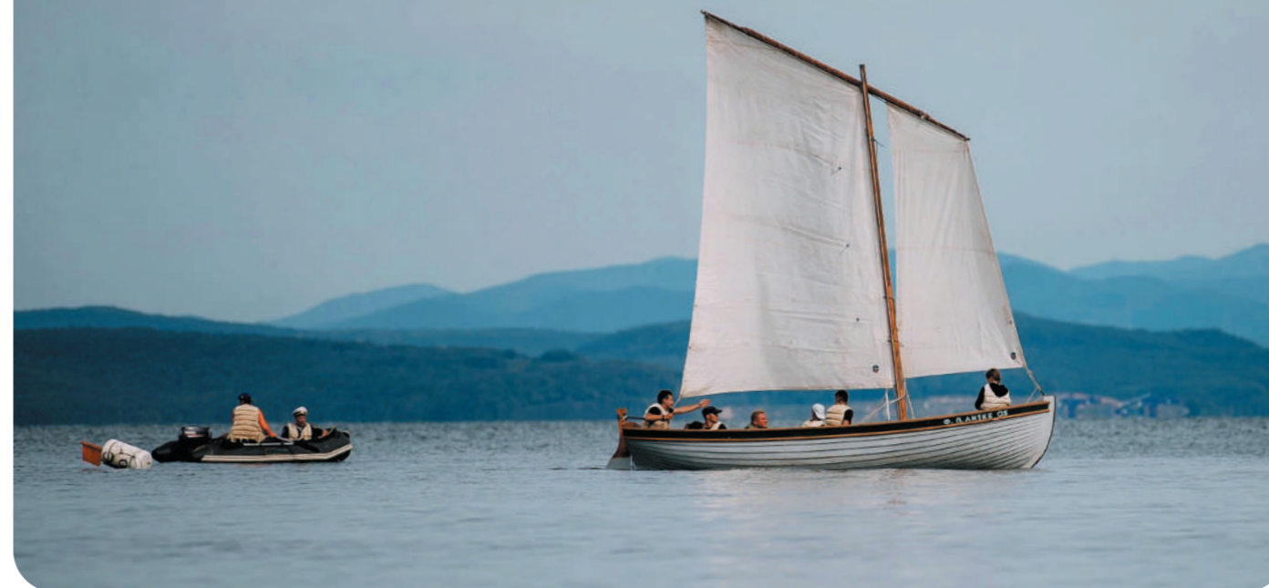
ЯЛ-6 в акватории ВДЦ «Океан». Судно имеет разрезное рейковое парусное вооружение
